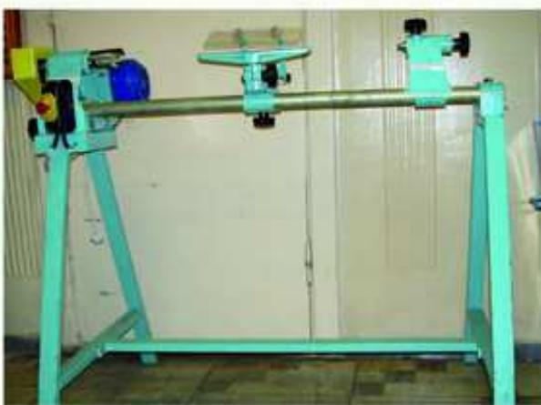
Станок токарный деревообрабатывающий бытовой
