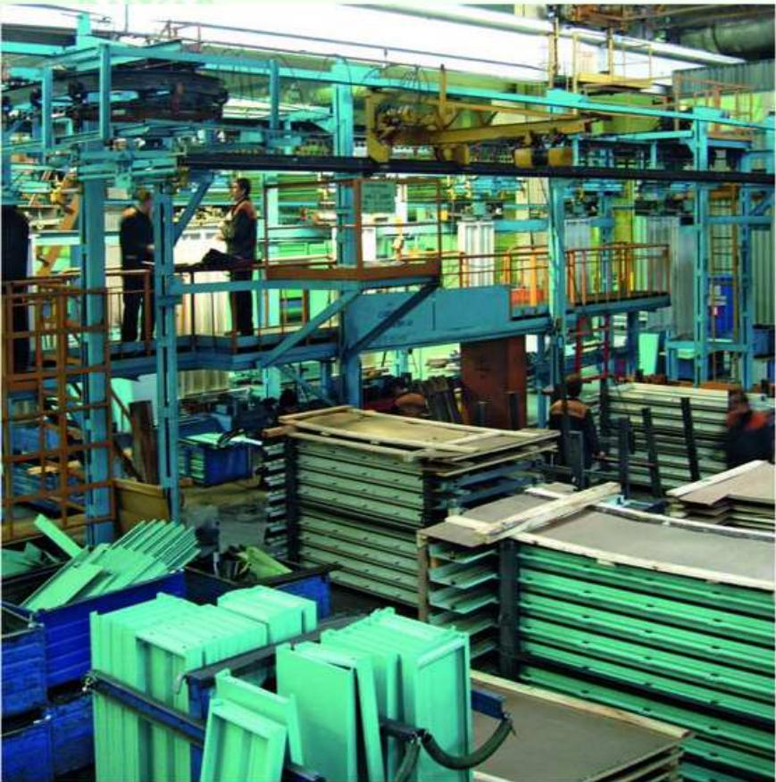
Сборочно-комплектовочный цех образован в числе первых на заводе – в 1969 году. В состав цеха входило четыре участка: сборки и упаковки кабин, сборки и упаковки дверей шахты, упаковки электроразводки и комплектующих по монтажу направляющих на шахте, окраски деталей и узлов лифта.
