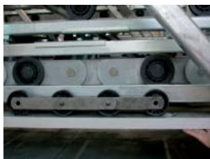
Цепь ступени с внешними роликами
