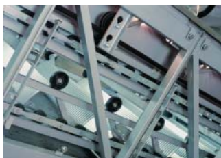
Цепь ступени с внутренними роликами
